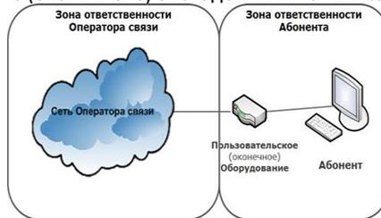
**СХЕМА ВКЛЮЧЕНИЯ ПОЛЬЗОВАТЕЛЬСКОГО (ОКОНЕЧНОГО) ОБОРУДОВАНИЯ ПО ТЕХНОЛОГИИ xPON**
